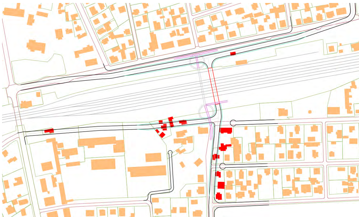
6.18 pav. Siūlomas transporto tinklo reorganizavimas, įrengiant transporto tunelį po geležinkeliu
